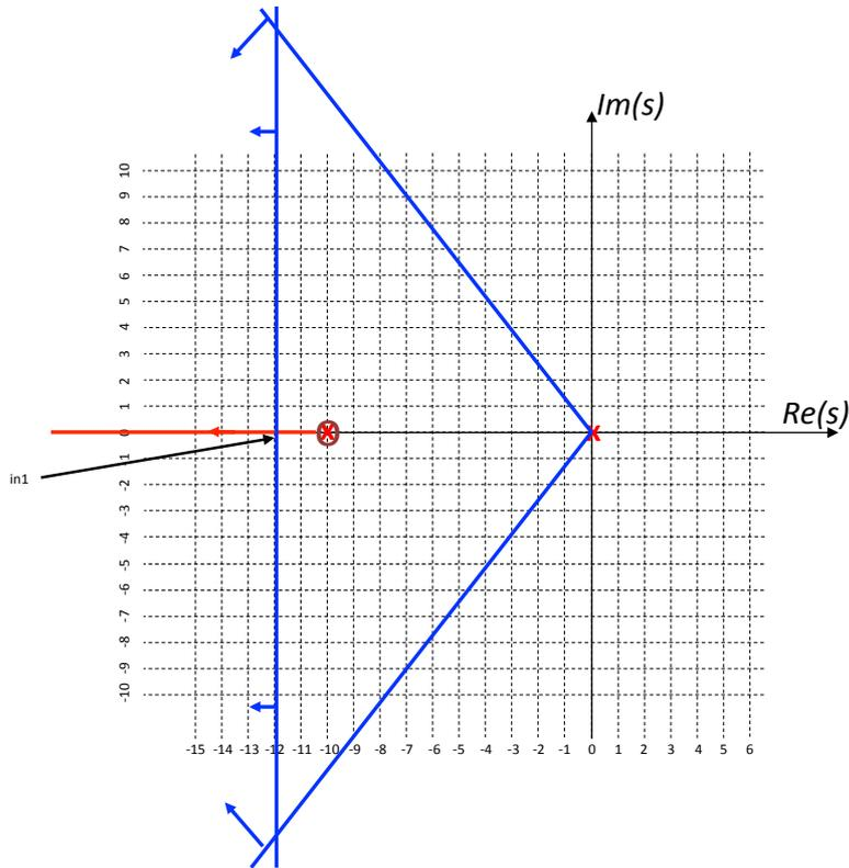
Es necesario ubicar el cero del controlador. Si con el cero del PD cancelamos el polo del sistema en  $s = -10$  quedará un sistema de primer orden (y se cumple la especificación de  $M_p$  para todo valor de  $K_c$ ).
