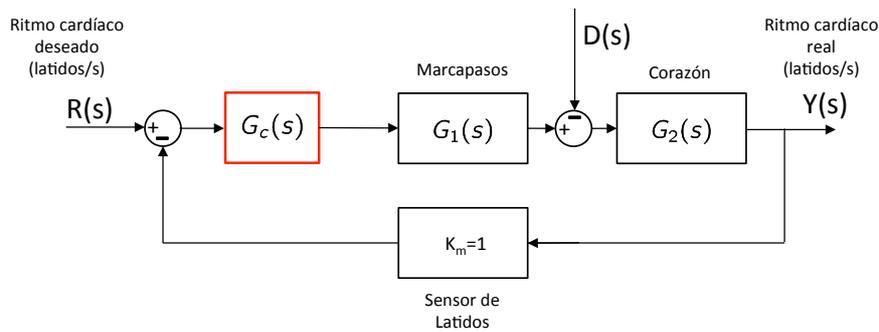
Figura 2.2. -Sistema de control de un marcapasos
