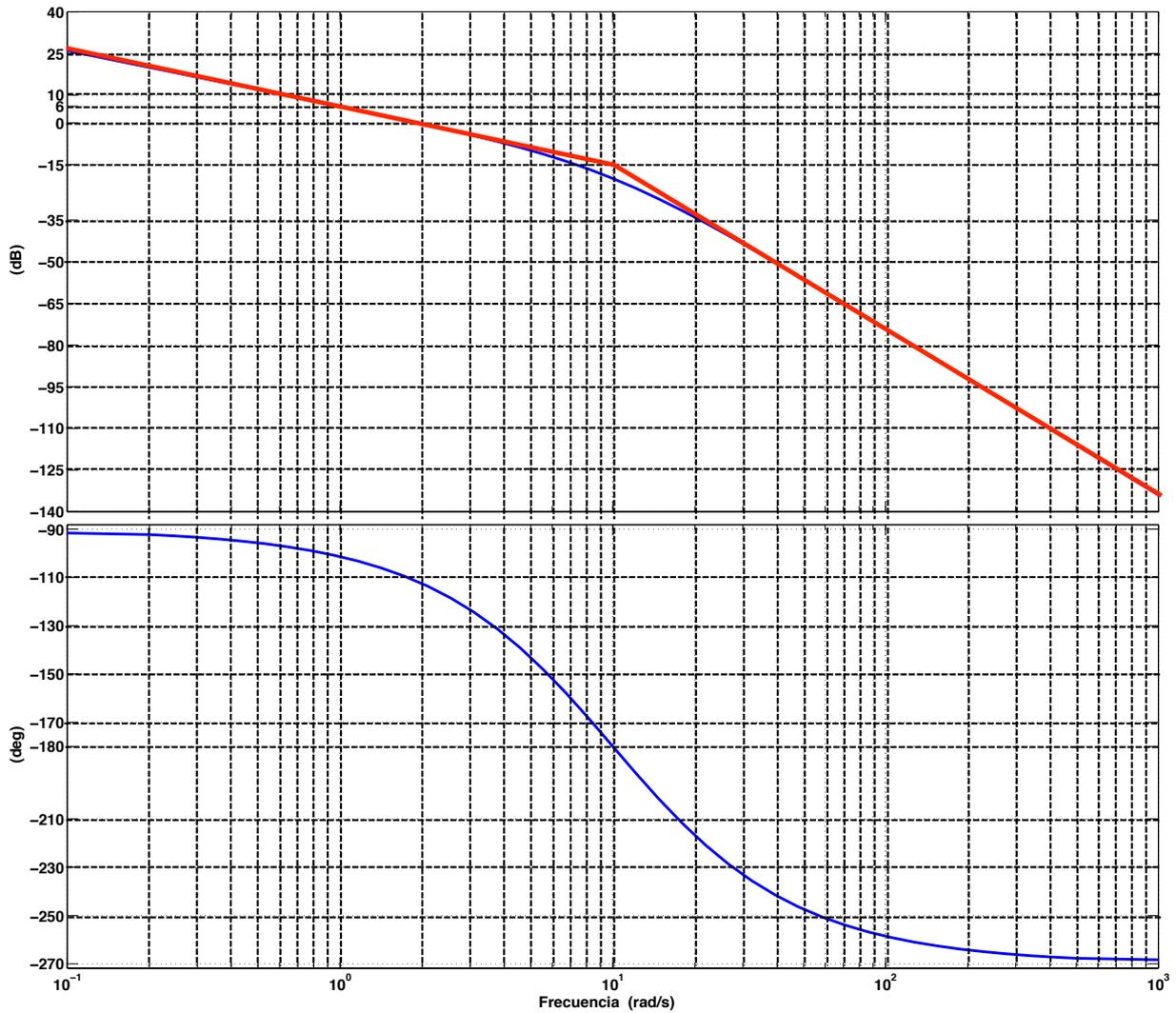
Figura 3.1. -Diagrama de Bode en lazo abierto del sistema
