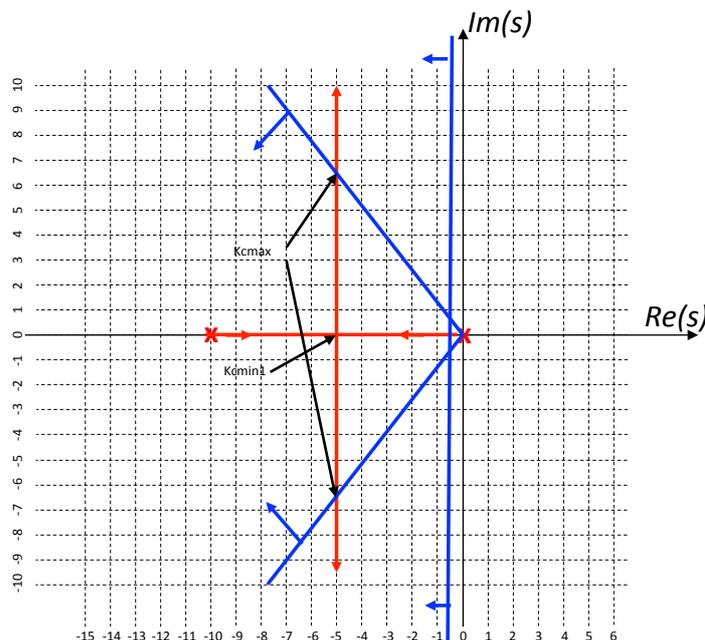
Como se observa, hay intersección entre la zona de especificaciones y el Lugar de las Raíces. En principio basta con un controlador Proporcional con ganancia perteneciente al intervalo  $K_{cmin} < K_c < K_{cmax}$ . Siendo:
